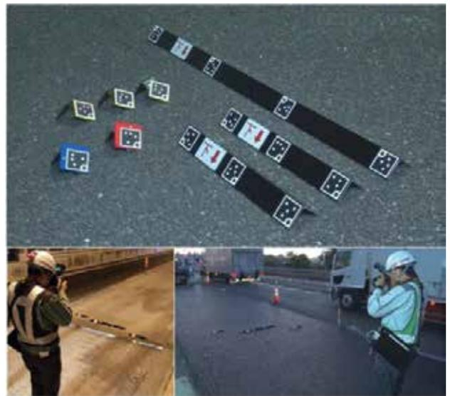
写真-8 基準スケールとターゲット(上) および測定状況(下)
