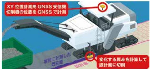
図-4 3D-RTCの概要
