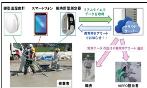
図-6 バイタルセンシングの概要
