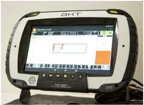
藤田さんが携わっている製品「HDT280」。位置情報に特化した自社開発の堅牢型Android端末。建設現場や海上などで重機や船舶に搭載され、働く現場をICTとクラウドで支えている。
