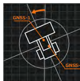
重機など移動体の方位を計測
