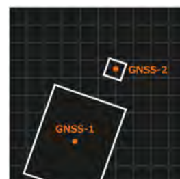
クレーン船の現在位置、クレーン先端の座標管理
